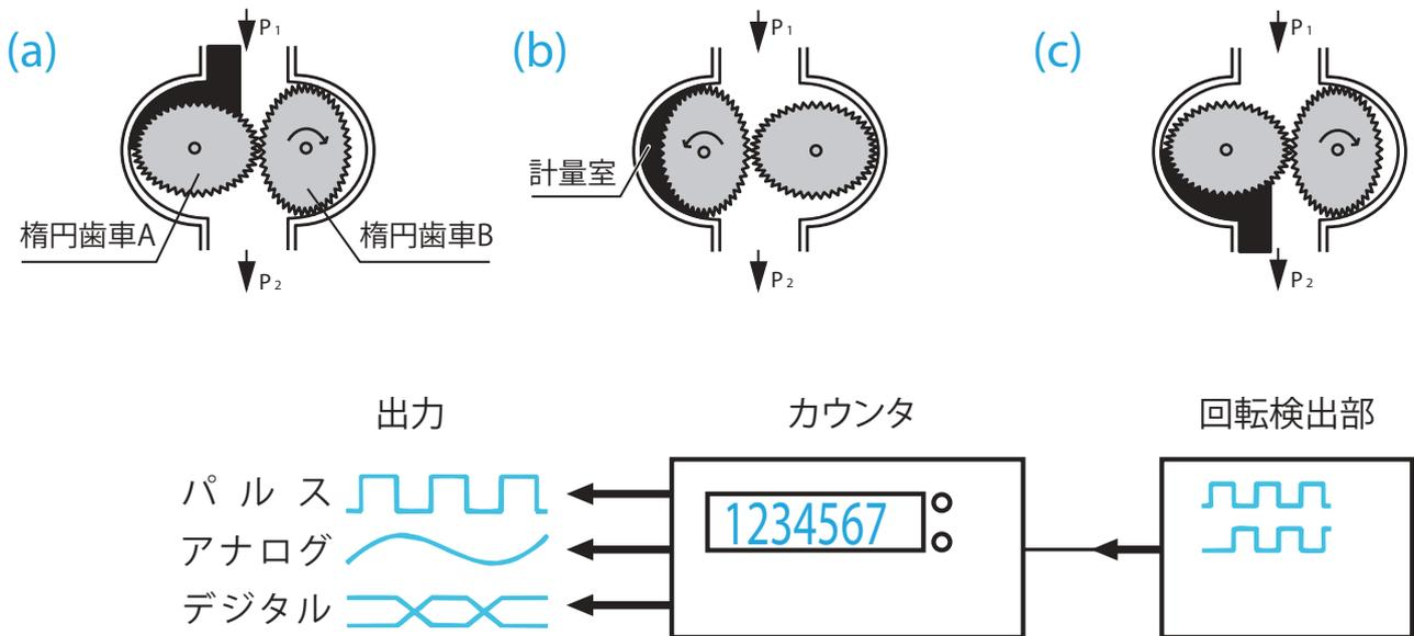
計量室内を通過する流体の圧力により、ギヤとギヤの端面に圧入された反射板が同期して回転します。反射板上に照射された光の反射光を回転検出部にて電圧パルス変換してカウンタに入力し、必要に応じた各種信号を出力します。
