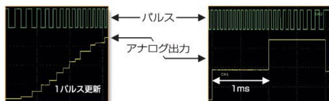
例えば、入力周波数が40 kHzの場合、25 μs毎にパルスが入力されますので、1パルス方式は1ms更新と比較すると約40倍の分解能が得られます。
