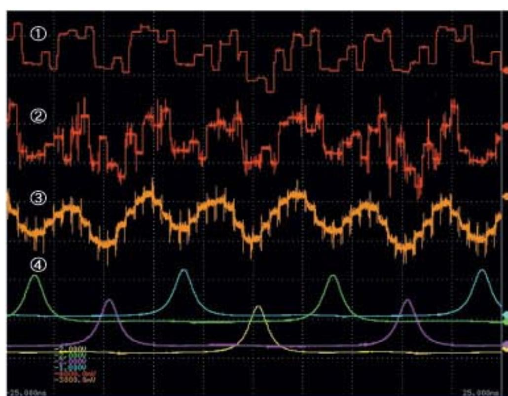
赤色の2つの波形は、トルクフランジからのパルス信号( $60\text{kHz} \pm 20\text{kHz}$ )をHS-TACに取り込んで1パルスごとにアナログ出力した波形です。トルクフランジの1ms更新のアナログ出力(オレンジ色の波形)と比較すると、より詳細にトルク変動を捉えています。
