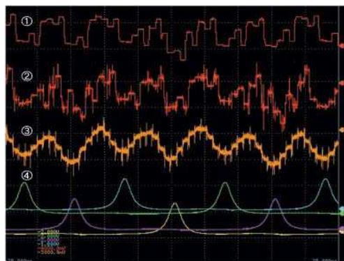
赤色の2つの波形は、トルクフランジからのパルス信号(60kHz $\pm$ 20kHz)をHS-TACに取り込んで1パルスごとにアナログ出力した波形です。トルクフランジの1ms更新のアナログ出力(オレンジ色の波形)と比較すると、より詳細にトルク変動を捉えています。
